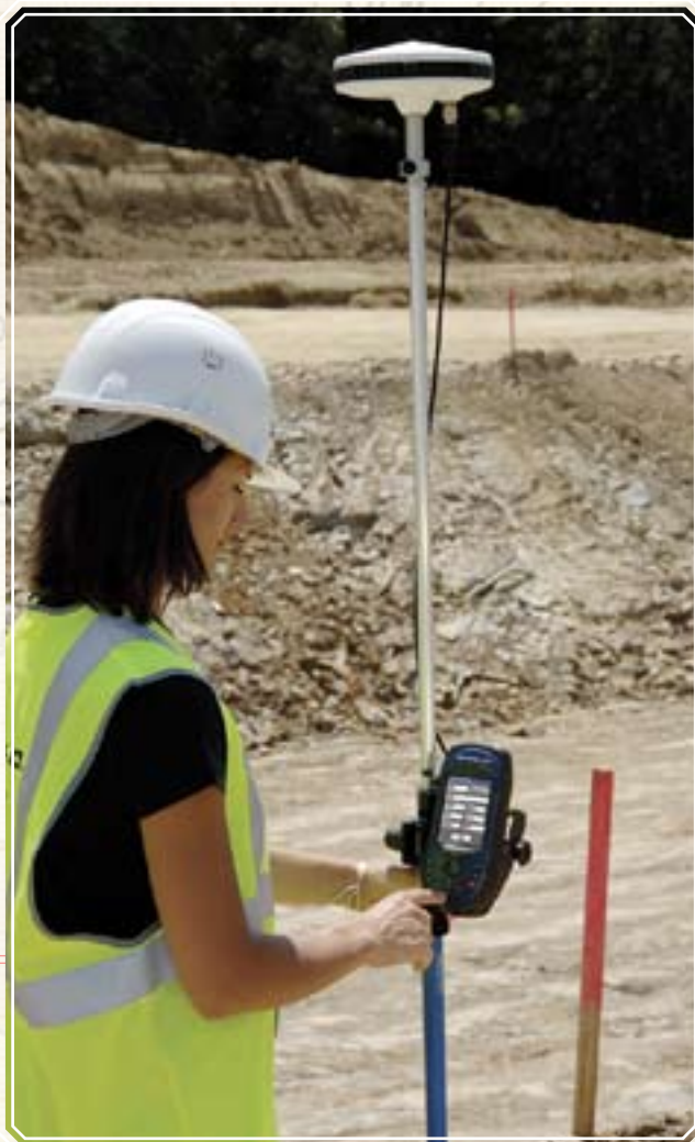
ПРИЕМНИК пылевлагозащищенный Диапазон рабочих t°: от - 10°С до 60°С Диапазон t° хранения: от - 20°С до 70°С
